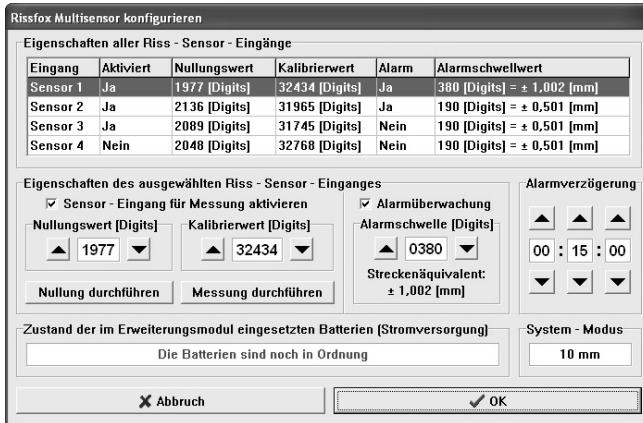
Abbildung 5: Konfigurationsfenster des Rissfox Multisensors
